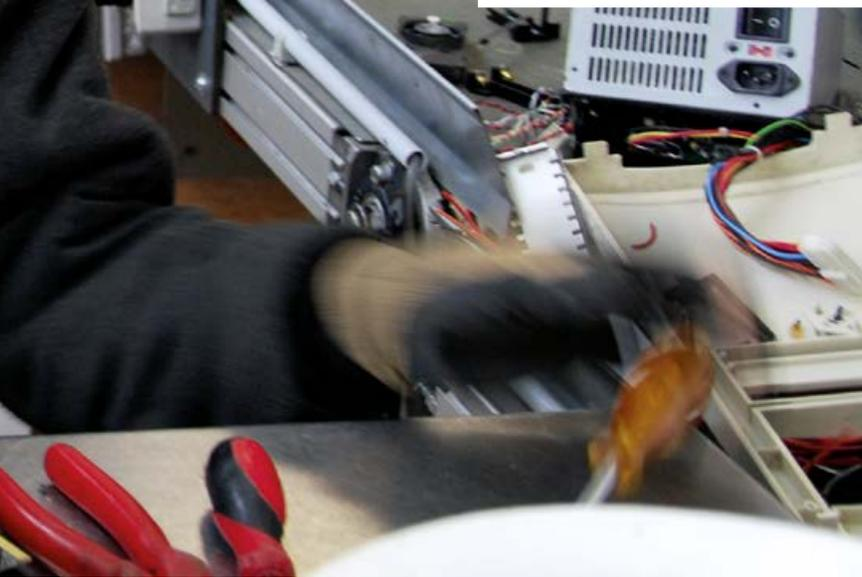
Im Recycling- und Zerlegebereich werden die Elektroaltgeräte per Hand demontiert und Wert- und Schadstoffe separiert.
